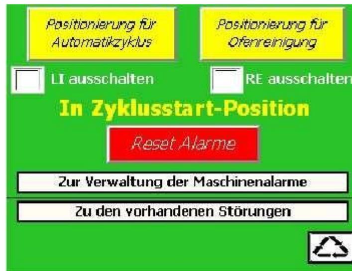
Wenn die Funktion der Anfangspositionierung erfolgt ist und keine Alarml im System vorhanden sind, zeigt der Touchscreen 5 Sekunden nach dem Schließen der Tür die Kundenseiten.
