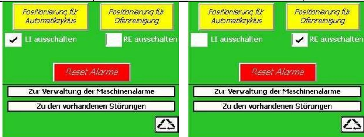
Falls im System Alarme aktiv sind, erscheint auf der Seite die Meldung **ALARM!!!!**. Durch Drücken der unteren Taste **Reset Alarme** werden die vorhandenen Alarme zurückgesetzt.
