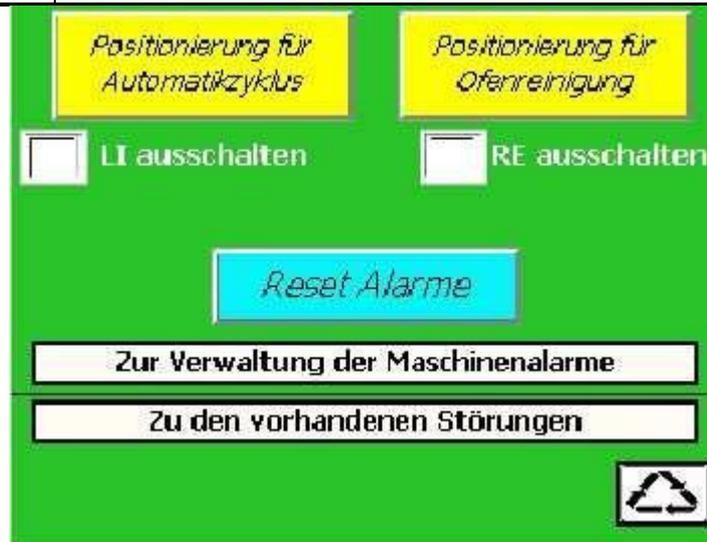
Die Maschine bereitet sich auf den Reinigungszustand vor und führt dazu die notwendigen Bewegungen durch, schiebt den Ofenrost nach vorne und bewegt den mobilen Backofen. Während dieser Vorgänge erscheint die Meldung **Positionierung für Ofenreinigung**. Nach Ende der Bewegungen erscheint die Meldung **In Reinigungsposition**.
